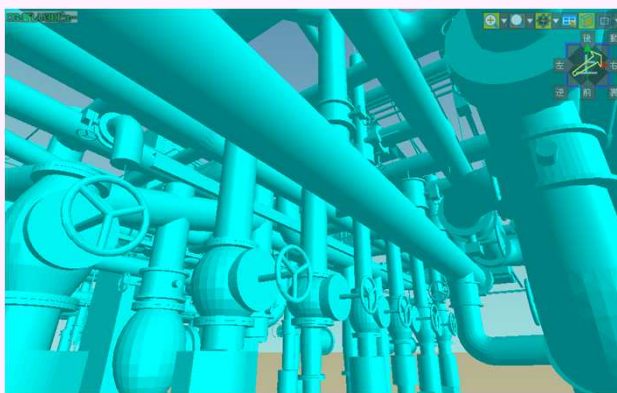
図4:CADEWAで読み込んだIFC変換された点群データ
